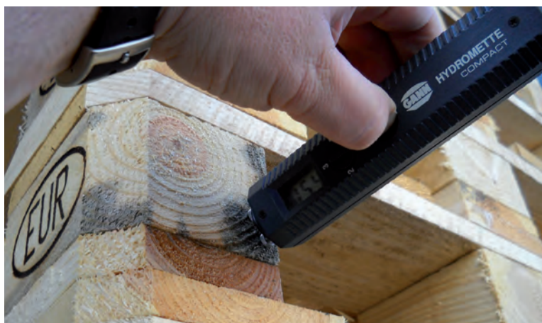
Un tecnico misura la percentuale di umidità su un pallet. La norma evidenzia anche le modalità di trasporto e stoccaggio del bancale onde evitare l'insorgere di problemi quali muffe e condizioni di elevata umidità, tali da danneggiare la merce
